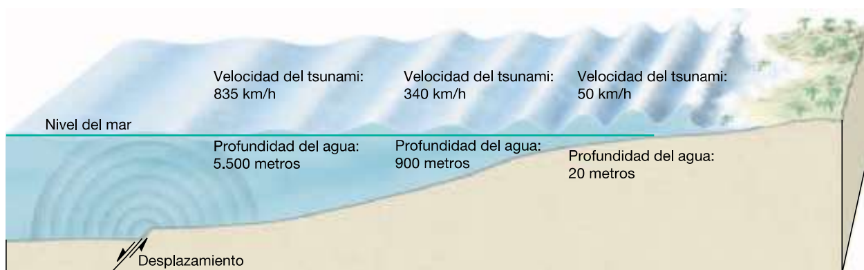
▲ Figura 11.18 Diagrama de un tsunami generado por desplazamiento del suelo oceánico. La velocidad de una ola está relacionada con la profundidad oceánica. Como se muestra, las olas que se mueven en agua profunda avanzan a velocidades que superan los 800 kilómetros por hora. La velocidad disminuye gradualmente hasta 50 kilómetros por hora a profundidades de 20 metros. La disminución de la profundidad reduce la velocidad del movimiento de la ola. A medida que las olas se ralentizan en agua superficial, crecen en altura hasta que se tambalean y se precipitan sobre la costa con tremenda fuerza. El tamaño y el espaciado de este oleaje no están representados a escala.
